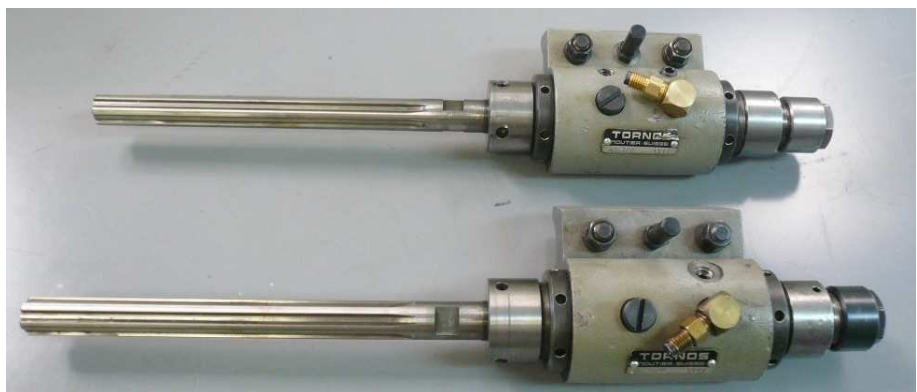
AS27/2 Rotating spindle fixed on centre block Broche tournante sur glissiere
